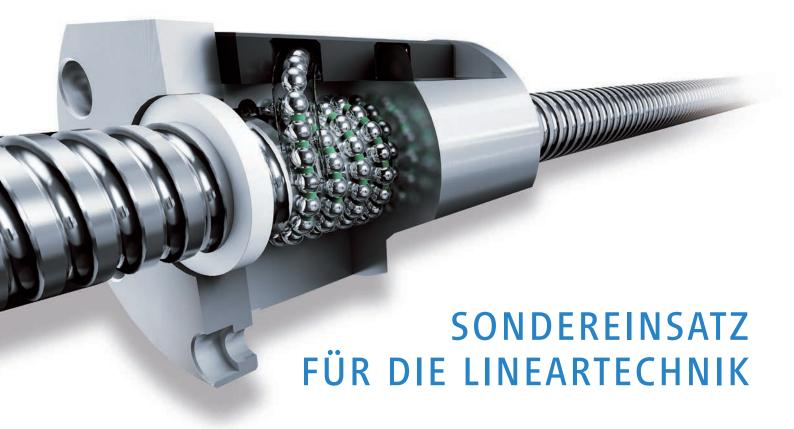
Kugelgewindetriebe werden da gebraucht, wo große Dynamik, hohe Präzision, lange Einschaltdauer und geringes Spiel gefordert sind. So auch in einem Bearbeitungszentrum für die Walzenlackierung, in dem die Walzen automatisch gereinigt werden sollen.
