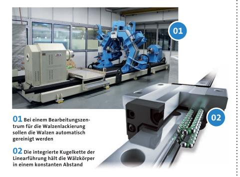
wegen der X-Anordnung der vier Kreisbogenlaufrillen mit Zwei-Punkt-Kontakt kompensiert der Führungswagen eventuelle Auswirkungen von Montagefehlern auf die Laufgenauigkeit selbst unter Vorspannung.
