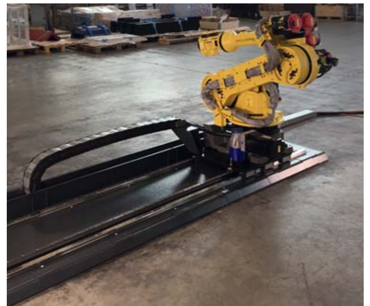
Mit den neuen Bodenfahrwerken lassen sich Knickarmroboter mit einem maximalen Gewicht von 500 Kilogramm millimetergenau verfahren. Bild: Indunorm
