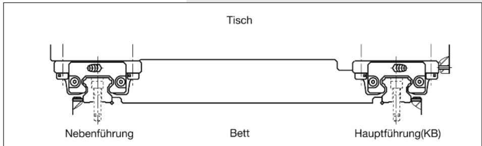
Abb. 8: Montage von THK-Linearführungen ohne Andruckschrauben an den Führungsschienen
