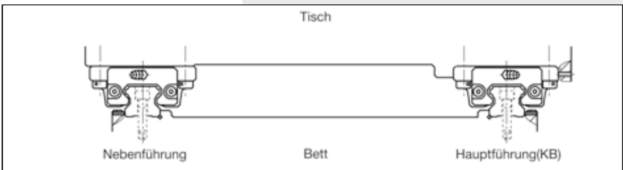
Abb. 14 Montage von THK-Linearführungen ohne Anschlagsschulter
